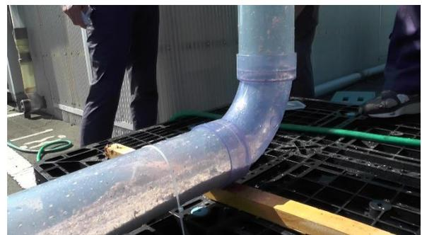
写真 4 上流からの洗浄後堆積状況
