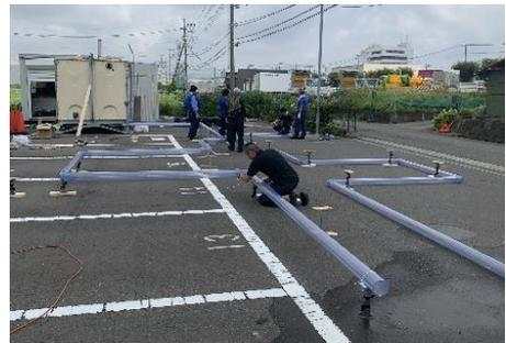
写真2 供試排水配管
